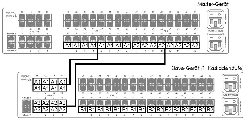
Hier werden die **CPU-Ports 1 bis 16** des Master-Geräts über jeweils ein Twisted-Pair-Kabel mit je einem **Console-Port** des Slave-Geräts verbunden.
