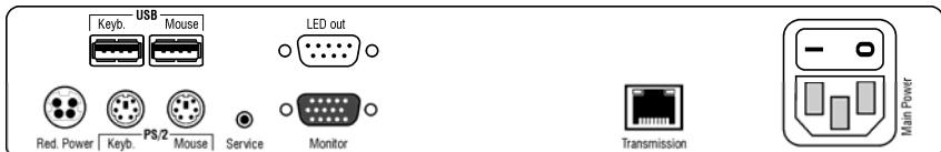
Auf der Rückseite des Arbeitsplatzmoduls *UCON* befinden sich an der RJ45-Schnittstelle zusätzliche Status-LEDs. Diese LEDs haben folgende Funktion:
