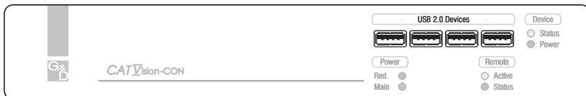
**USB 2.0 Devices:** Stecken Sie an diese Schnittstellen bis zu vier USB-Geräte an.
