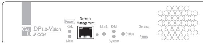
**HINWEIS:** Verbinden Sie diese Netzwerkschnittstelle – falls gewünscht – mit einem lokalen Netzwerk, um aus diesem Netzwerk auf die Webapplikation **Config Panel** zuzugreifen und beispielsweise Syslog-Meldungen in diese Netzwerke zu senden.
