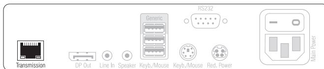
**Transmission:** Stecken Sie ein als Zubehör erhältliches Twisted-Pair-Kabel der Kategorie 5e (oder höher) ein. Das andere Ende des Kabels ist mit dem Gigabit-Ethernet zu verbinden.
