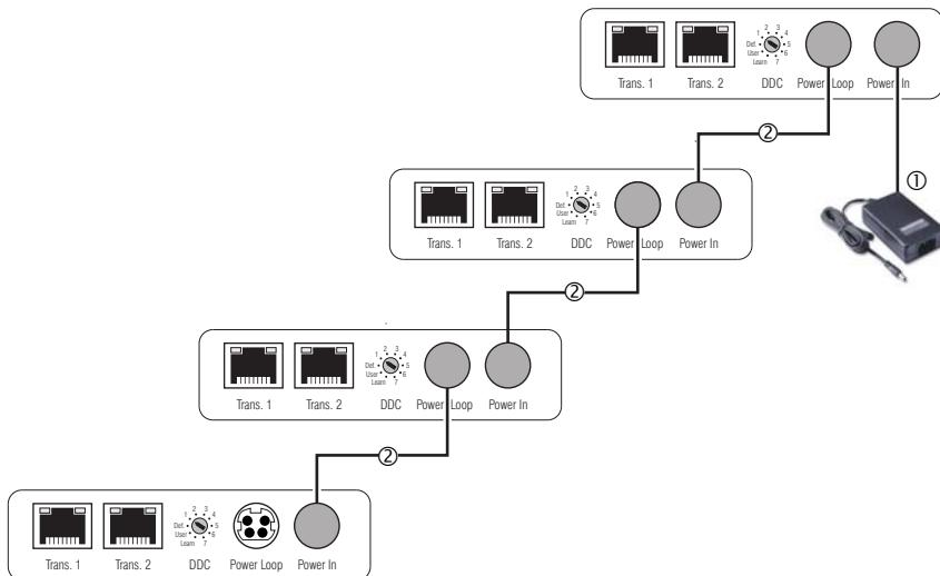
Abbildung 8: Power-Loop-Stromversorgung von vier Geräten über ein Tischnetzteil
