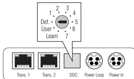
**Abbildung 7: Detailansicht des DDC-Drehschalters**
