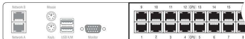
Abbildung 1: »CPU«-Schnittstellen am Matrixswitch
