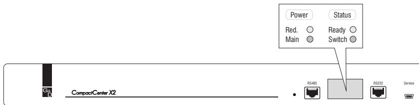
Abbildung 3: Statusanzeigen an der Front des Matrixswitches
