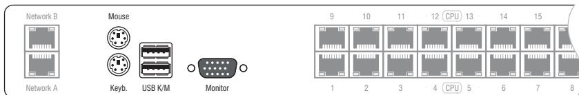
Abbildung 2: Schnittstellen zum Anschluss des lokalen Arbeitsplatzes
