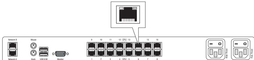
**Abbildung 4: Statusanzeigen an den RJ45-Schnittstellen des Matrixswitches**
