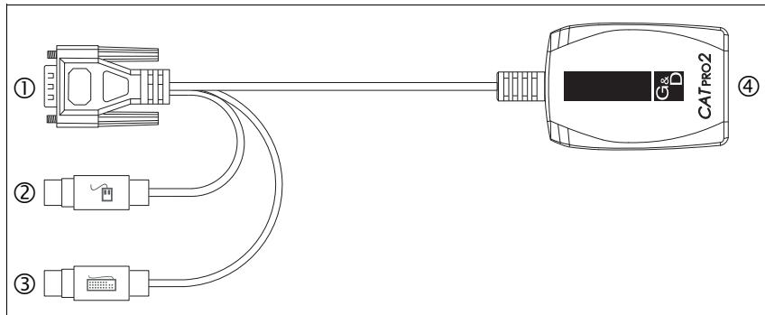
Abbildung 1: Skizze des Target-Moduls *CATpro2-PS/2*
