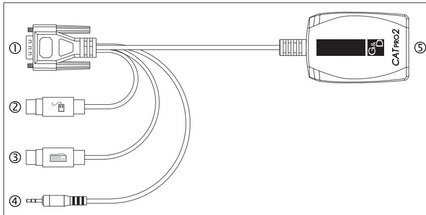
Abbildung 3: Skizze des Target-Moduls *CATpro2-Audio-PS/2*
