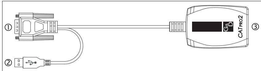
Abbildung 2: Skizze des Target-Moduls **CATpro2-USB**
