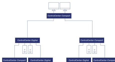
Aufgrund der Top-Down-Struktur der Kaskade können Arbeitsplatzmodule und DWCs nur solche Rechnermodule aufschalten, die an denselben Matrixswitch, wie das Arbeitsplatzmodul oder die DWC, oder an einen in der Baumstruktur untergeordneten (kaskadierten) Matrixswitch angeschlossen sind.
