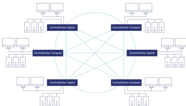
Alle Arbeitsplatzmodule und DWCs können auf jedes beliebige Rechnermodul (unabhängig vom Matrixswitch, an den sie angeschlossen sind) aufgeschaltet werden.
