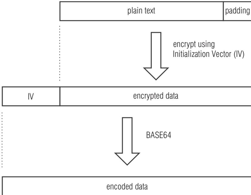
Das **Padding** wird benötigt, um den zu verschlüsselnden Datenblock auf ein Vielfaches der Blockgröße (8 Bytes) zu bringen. Die XML-API erwartet, dass das letzte Byte des Padding die Anzahl hinzugefügter Füllbytes angibt. Die Füllbytes selbst sind zufällig zu wählen.
