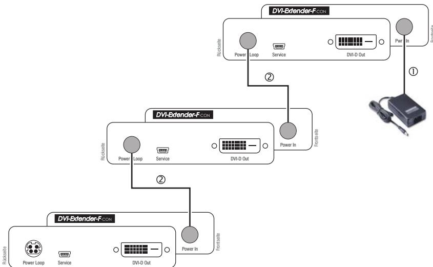
4. Wiederholen Sie Schritt 3. zum Anschluss weiterer (maximal sieben) Extender.
