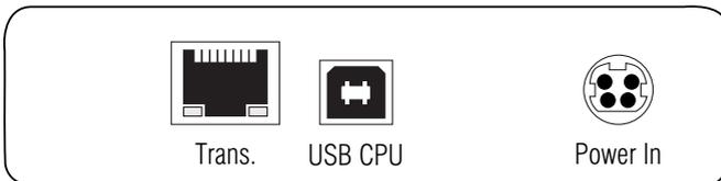
**WICHTIG:** Verbinden Sie pro Zentralmodul ausschließlich eine *Transmission-Schnittstelle* des Target-Moduls!
