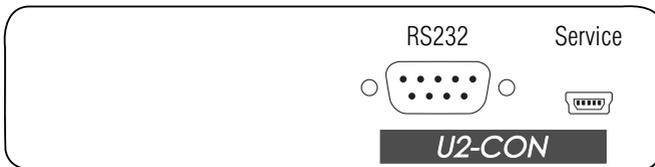
**RS232:** Verbinden Sie das serielle Endgerät mit dieser Schnittstelle.
