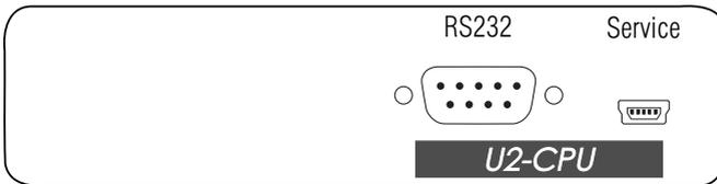
**RS232:** Verbinden Sie eine 9-polige serielle Schnittstelle des Computers mit dieser Schnittstelle. Verwenden Sie hierzu das Kabel RS232-M/F-2.
