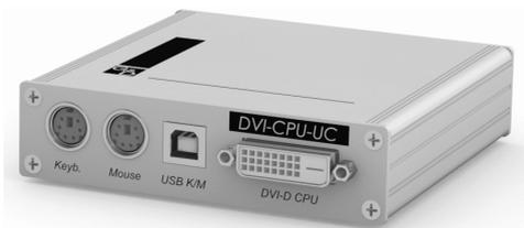
Hierzu verbinden Sie zunächst den Computer mit dem Target-Modul. Anschließend verbinden Sie das Target-Modul mit zwei Zentralmodulen der *DVICenter*-Serie.
