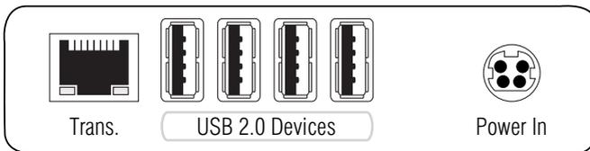
**Trans.:** Verbinden Sie diese Schnittstelle mit dem *Dynamic Port* des *USB/RS232 Main Channels*, der dem Arbeitsplatz zugeordnet ist.
