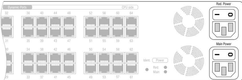
**Main Power:** Schließen Sie ein mitgeliefertes Stromversorgungskabel an. Verbinden Sie das Stromversorgungskabel mit einer Netzsteckdose und schalten Sie den Netzschalter ein.
