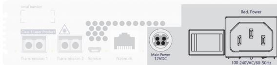
**Power/Main Power:** Schließen Sie die externe Spannungsversorgung an diese Buchse an.
