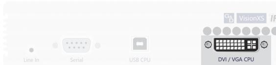
**DVI/VGA CPU:** Verbinden Sie den Videoausgang des Rechners mit dieser Schnittstelle. Verwenden Sie hierzu das Kabel *DVI-D-DL-M/M-2* oder *VGA-M/DVI-A-M-2*.
