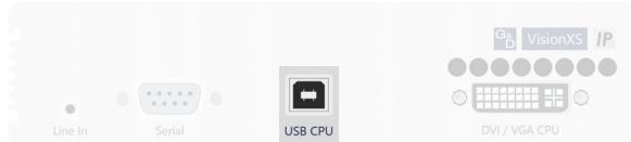
**USB CPU:** Verbinden Sie eine USB-Schnittstelle des Rechners mit dieser Schnittstelle. Verwenden Sie hierzu das Kabel **USB-AM/BM-2**.
