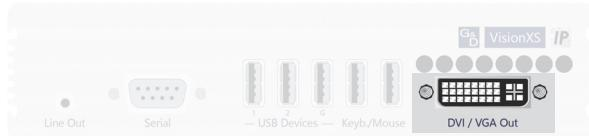
**DVI/VGA Out:** Schließen Sie den Monitor des Arbeitsplatzes an.
