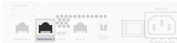
**Transmission 2:** Stecken Sie ein als Zubehör erhältliches Twisted-Pair-Kabel der Kategorie 6 (oder höher) ein. Das andere Ende des Kabels ist mit der entsprechenden Schnittstelle des Arbeitsplatzmoduls zu verbinden.
