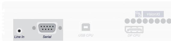
**Line In:** Verbinden Sie die *Line-Out*-Schnittstelle des Rechners mit dieser Schnittstelle. Verwenden Sie hierzu ein Audio-Anschlusskabel *Audio-M/M-2*.
