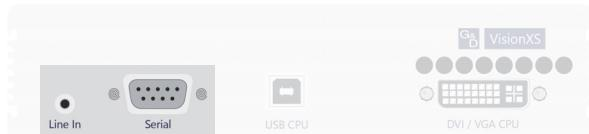
**Line In:** Verbinden Sie die *Line-Out*-Schnittstelle des Rechners mit dieser Schnittstelle. Verwenden Sie hierzu ein Audio-Anschlusskabel *Audio-M/M-2*.
