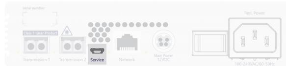
In einem Terminalemulationsprogramm (beispielsweise *HyperTerminal* oder *PuTTY*) können Debug-, Fehler- und Statusmeldungen angezeigt werden. Über ein Service-Menü haben Techniker die Möglichkeit, Informationen über das Gerät auszulesen, das Gerät auf die Werkseinstellungen zurückzusetzen oder einen Neustart durchzuführen.
