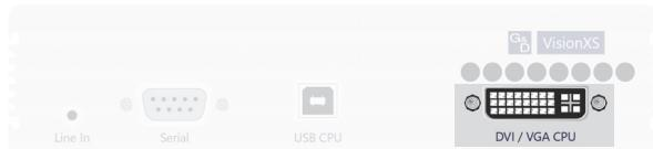
**DVI/VGA CPU:** Verbinden Sie den Videoausgang des Rechners mit dieser Schnittstelle. Verwenden Sie hierzu das passende Videokabel.
