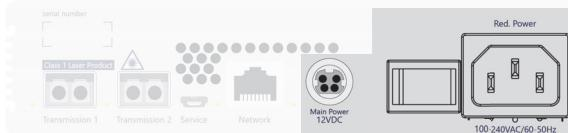
**Power/Main Power:** Schließen Sie eine externe Spannungsversorgung an diese Buchse an.
