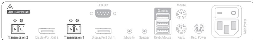
**Transmission 1 | Tx:** Stecken Sie den LC-Stecker eines kompatiblen Lichtwellenleiters ein. Verbinden Sie das andere Ende des Kabels mit der **Rx**-Schnittstelle eines *Dynamic Ports* des Matrixswitches.
