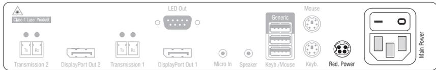
**Main Power:** Schließen Sie das mitgelieferte Stromversorgungskabel an. Stecken Sie den Schukostecker des Kabels in eine Netzsteckdose.
