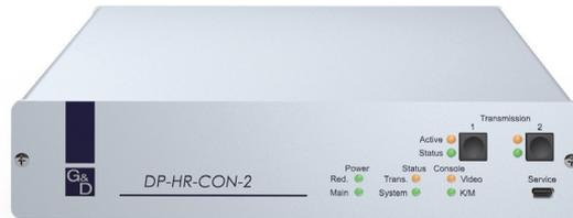
Am eingerichteten Arbeitsplatz können sich die Benutzer der Matrixswitches auf ein Rechnermodul aufschalten und den angeschlossenen Computer bedienen.
