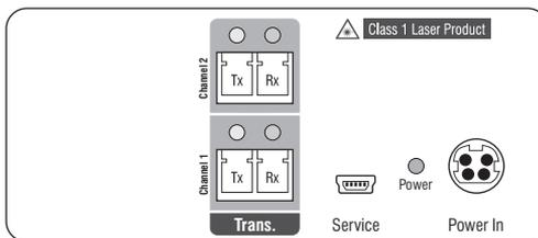
**Trans. | Channel 1 | Tx:** Stecken Sie den LC-Stecker eines kompatiblen Lichtwellenleiters ein. Verbinden Sie das andere Ende des Kabels mit der **Rx**-Schnittstelle eines *Dynamic Ports* des Matrixswitches.
