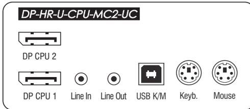
**DP CPU 1:** Verbinden Sie den ersten *DisplayPort*-Videoausgang des Computers mit dieser Schnittstelle. Verwenden Sie hierzu ein mitgeliefertes Videokabel.
