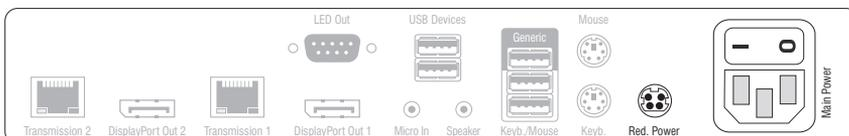
**Main Power:** Schließen Sie das mitgelieferte Stromversorgungskabel an. Stecken Sie den Schukostecker des Kabels in eine Netzsteckdose.
