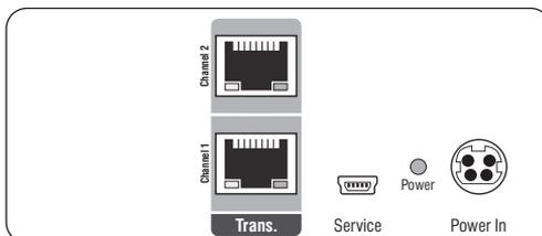
**Trans. | Channel 1:** Verbinden Sie die Schnittstelle mit einem *Dynamic Port* (RJ45) des Matrixswitches.
