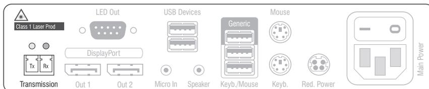
**Transmission | Tx:** Stecken Sie den LC-Stecker eines kompatiblen Lichtwellenleiters ein. Verbinden Sie das andere Ende des Kabels mit der **Rx**-Schnittstelle eines *Dynamic Ports* des Matrixswitches.
