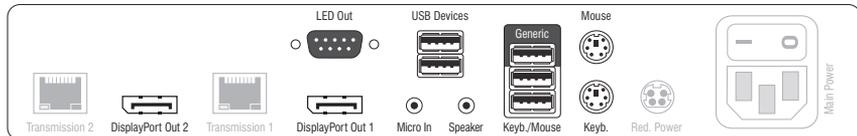
**DisplayPort Out 1:** Schließen Sie den ersten Monitor des Arbeitsplatzes an.
