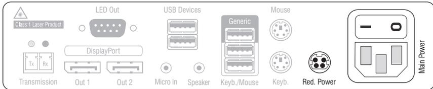
**Main Power:** Schließen Sie das mitgelieferte Stromversorgungskabel an. Stecken Sie den Schukostecker des Kabels in eine Netzsteckdose.
