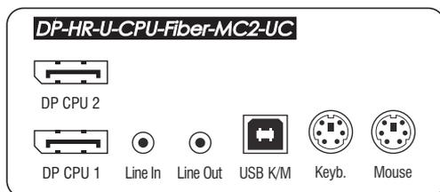
**DP CPU 1:** Verbinden Sie den ersten *DisplayPort*-Videoausgang des Computers mit dieser Schnittstelle. Verwenden Sie hierzu ein mitgeliefertes Videokabel.
