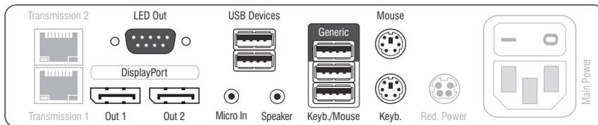
**DisplayPort Out 1:** Schließen Sie den ersten Monitor des Arbeitsplatzes an.
