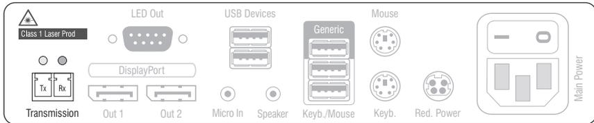
Auf der Rückseite des Arbeitsplatzmoduls befinden sich an der *Transmission*-Schnittstelle zusätzliche Status-LEDs.
