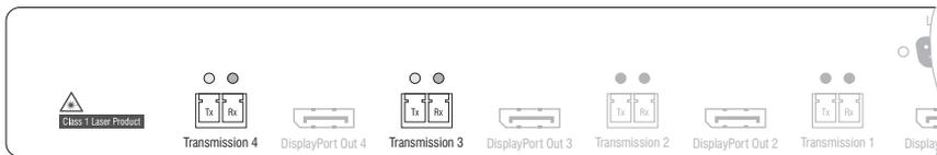
**Transmission 3 | Tx:** Stecken Sie den LC-Stecker eines kompatiblen Lichtwellenleiters ein. Verbinden Sie das andere Ende des Kabels mit der **Rx**-Schnittstelle eines weiteren *Dynamic Ports* des Matrixswitches.
