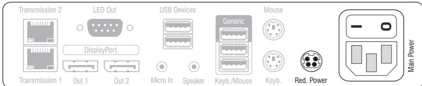
**Main Power:** Verbinden Sie das Stromversorgungskabel mit dem Netzteil und einer Netzsteckdose.
