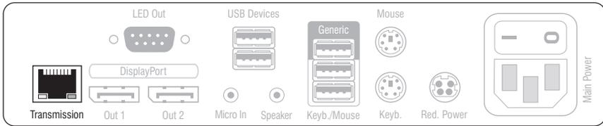
Auf der Rückseite des Arbeitsplatzmoduls befinden sich an den *Transmission*-Schnittstellen zusätzliche Status-LEDs.
