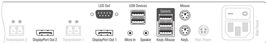
**DisplayPort Out 1:** Schließen Sie den ersten Monitor des Arbeitsplatzes an.
