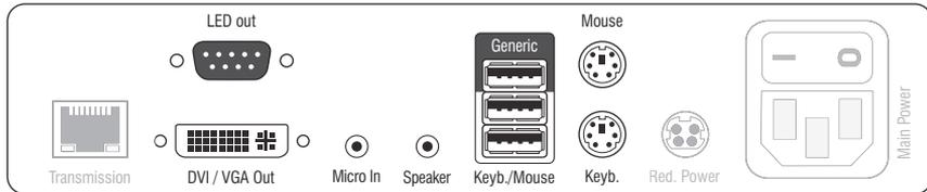
**HINWEIS:** Tastatur und Maus des Arbeitsplatzes können wahlweise über die USB- oder die PS/2-Schnittstellen des Arbeitsplatzmoduls angeschlossen werden.
