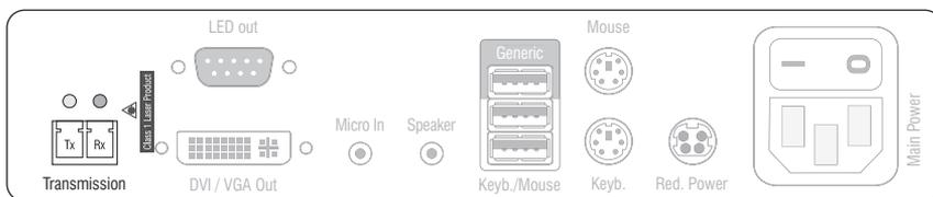
**Transmission | Tx:** Stecken Sie den LC-Stecker eines Lichtwellenleiters ein. Verbinden Sie das andere Ende des Kabels mit der **Rx**-Schnittstelle eines kompatiblen *Dynamic Ports* des Matrixswitches.
