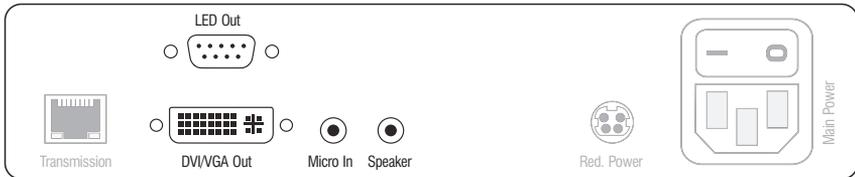
**DVI/VGA Out:** Schließen Sie den Monitor/Beamer des lokalen Arbeitsplatzes an.
