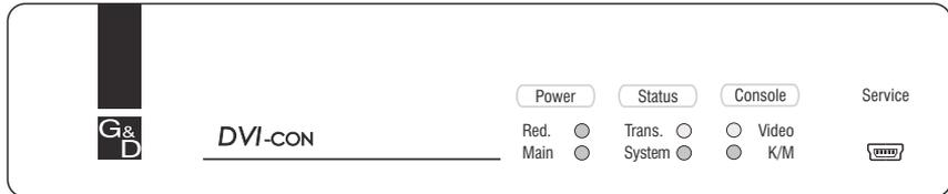
Die LEDs an der Frontseite des Arbeitsplatzmoduls geben Ihnen die Möglichkeit, den Betriebsstatus des Systems jederzeit zu kontrollieren.
