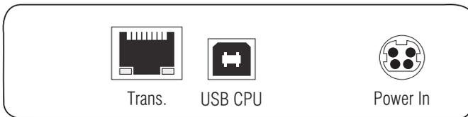
**Trans.:** Verbinden Sie diese Schnittstelle mit dem *Dynamic Port* des *USB/RS232 Main Channels*, der dem Computer zugeordnet ist.
