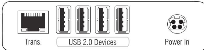
**Trans.:** Verbinden Sie diese Schnittstelle mit dem *Dynamic Port* des *USB/RS232 Main Channels*, der dem Arbeitsplatz zugeordnet ist.
