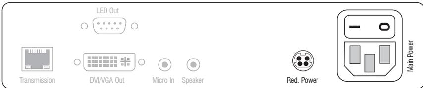
**Main Power:** Verbinden Sie das Stromversorgungskabel mit dem Netzteil und einer Netzsteckdose.
