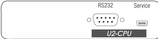
**RS232:** Verbinden Sie optional eine 9-polige serielle Schnittstelle des Computers mit dieser Schnittstelle. Verwenden Sie hierzu das RS232-Kabel.
