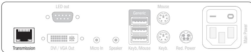
**Transmission:** Verbinden Sie die *Transmission*-Schnittstelle mit einem *Dynamic Port* (RJ45) des Matrixswitches.
