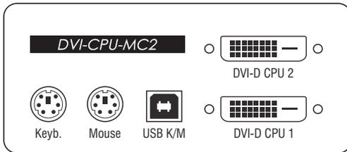
**HINWEIS:** Die Tastatur- und Maus-Signale können *wahlweise* über die PS/2-Schnittstellen oder die USB-Schnittstelle an den Computer übertragen werden.
