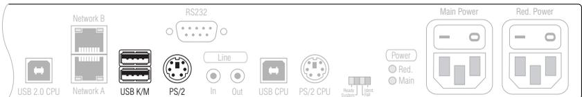
**HINWEIS:** Möchten Sie einen lokalen Arbeitsplatz am Rechnermodul einrichten, können Sie die Maus und die Tastatur des lokalen Arbeitsplatzes *wahlweise* als USB- (Schnittstellen *USB K/M*) oder als PS/2-Gerät (Schnittstellen *PS/2*) anschließen. Verwenden Sie bei Bedarf den Adapter **MD6M-2xMD6F** (A6400043) zum gleichzeitigen Anschluss einer PS/2-Tastatur und einer PS/2-Maus.
