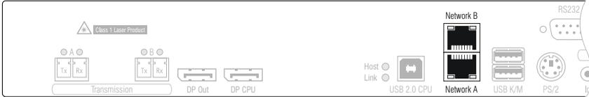
**HINWEIS:** Verbinden Sie – falls gewünscht – die Netzwerkschnittstellen mit bis zu zwei lokalen Netzwerken, um aus den Netzwerken auf die Webapplikation **Config Panel** zuzugreifen und beispielsweise Syslog-Meldungen in diese Netzwerke zu senden.
