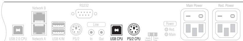
**USB CPU:** Verbinden Sie eine USB-Schnittstelle des Rechners mit dieser Schnittstelle. Verwenden Sie hierzu das Kabel *USB-AM/BM-2*.
