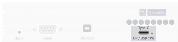
**Type-C DP/USB CPU:** Verbinden Sie eine USB-Schnittstelle des Rechners mit dieser Schnittstelle. Verwenden Sie hierzu das Kabel *Type-C-Cable-M/M-2*.
