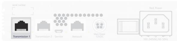
**Transmission 1:** Stecken Sie ein als Zubehör erhältliches Twisted-Pair-Kabel der Kategorie 6 (oder höher) ein. Das andere Ende des Kabels ist mit der entsprechenden Schnittstelle des Rechnermoduls oder einem Dynamic Port eines kompatiblen Matrixswitches (s. Seite 4) zu verbinden.
