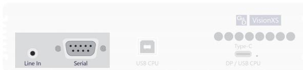
**Line In:** Verbinden Sie die *Line-Out*-Schnittstelle des Rechners mit dieser Schnittstelle. Verwenden Sie hierzu ein Audio-Anschlusskabel *Audio-M/M-2*.
