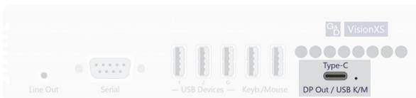
**Type-C/DP Out/USB K/M:** Schließen Sie den Monitor des Arbeitsplatzes an.
