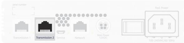
**Transmission 2:** Stecken Sie ein als Zubehör erhältliches Twisted-Pair-Kabel der Kategorie 6 (oder höher) ein. Das andere Ende des Kabels ist mit der entsprechenden Schnittstelle des Rechnermoduls zu verbinden.
